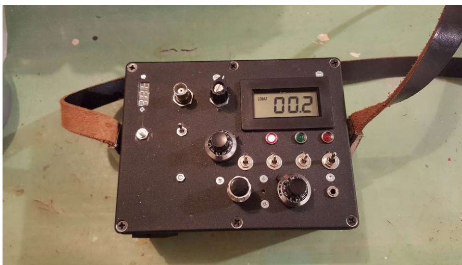
Récepteur à quadrature de phase (« Pease »)
