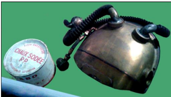
En haut, un vieux recycleur et sa boîte de soude! En bas, Un recycleur russe d'entre les deux guerres.
