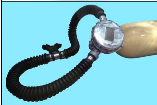
Le premier détendeur Cousteau-Gagnan avec l'embout et son modèle Mistral de 1946.
