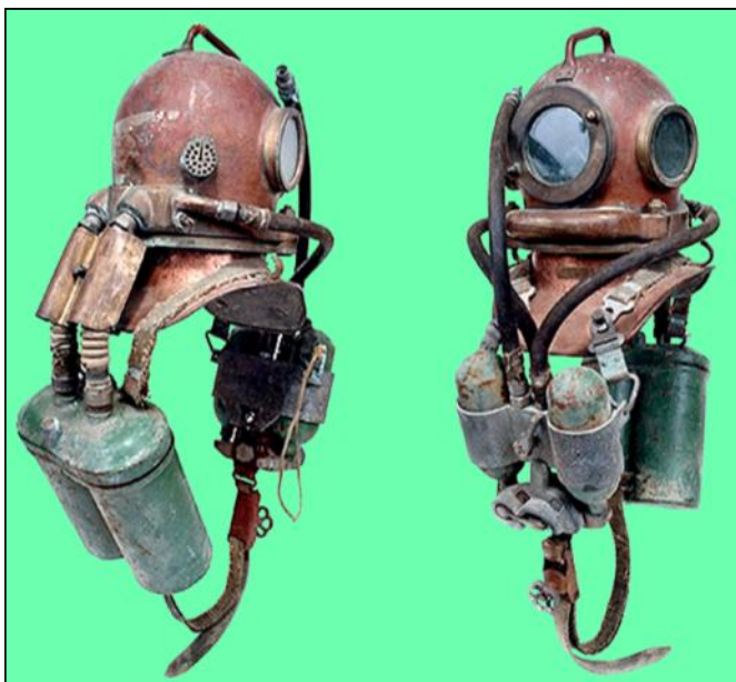
En haut, un vieux recycleur et sa boîte de soude! En bas, Un recycleur russe d'entre les deux guerres.
