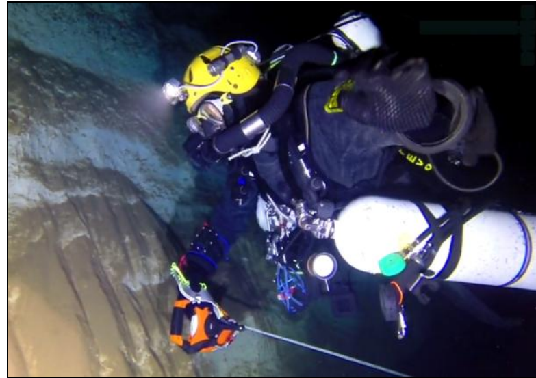
Mesure des distances avec un ruban topographique de 50 m.
