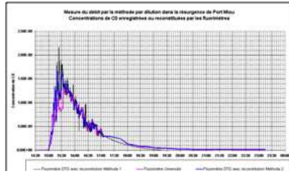
Fig. 1 : injection de la fluorescéine par les plongeurs Fig. 2 : évolution de la concentration de fluorescéine au niveau du barrage
