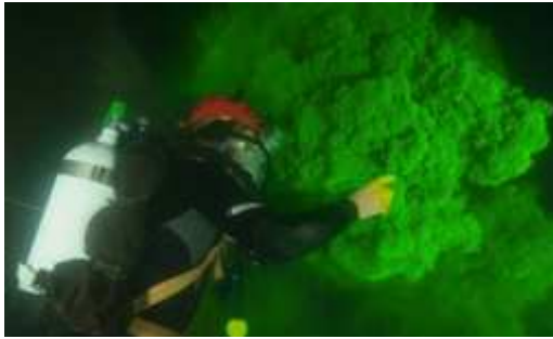
Fig. 1 : injection de la fluorescéine par les plongeurs Fig. 2 : évolution de la concentration de fluorescéine au niveau du barrage
