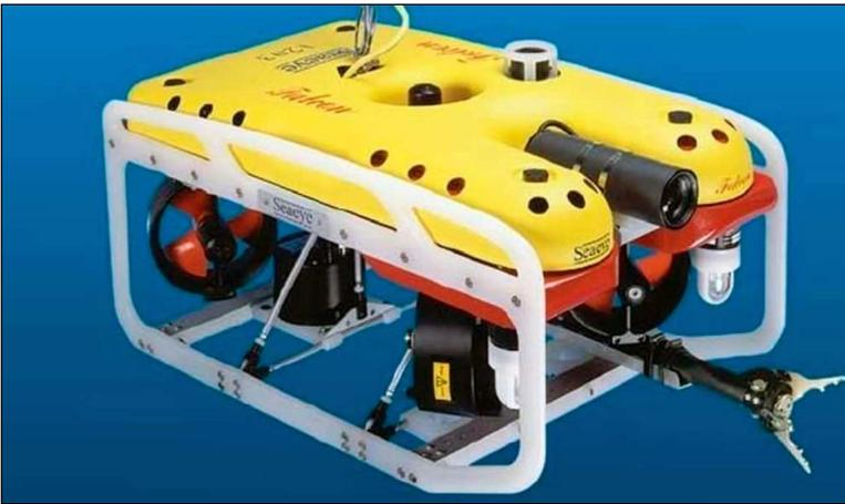
SAAB construit même des ROV! Celui-ci a une petite pince permettant de prélever un petit échantillon.
