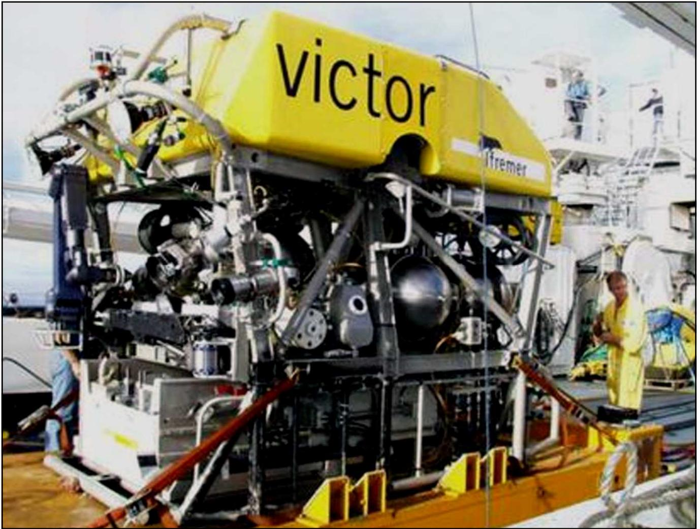
En haut, le ROV Victor d'Ifremer. D'un poids de 600 kg et de près de 3 m de long, il nécessite une grue pour le mettre à la mer.
