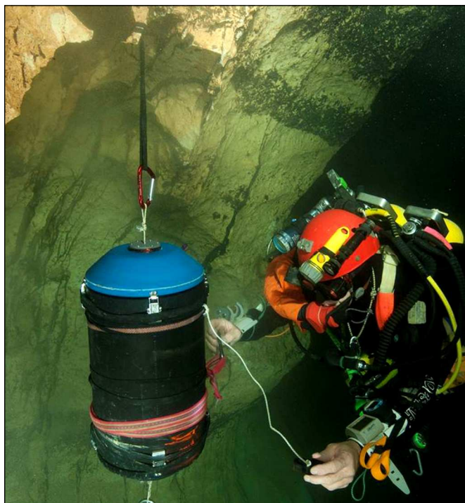
En haut, la balise a été suspendue au plafond, de manière à ce que son axe soit bien vertical (Cl. H. Chauvez).
