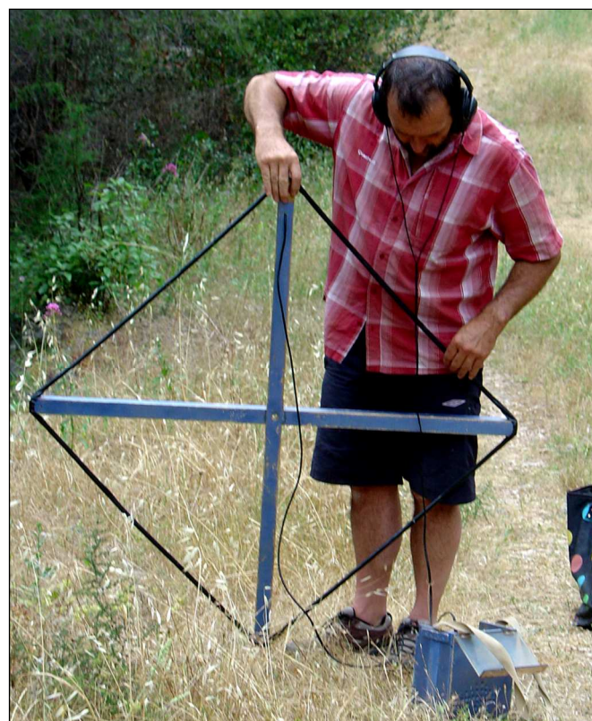
En bas, le cadre a été agrandi de manière à mieux capter le champ magnétique de la balise. (Cl. G. Acquaviva)
