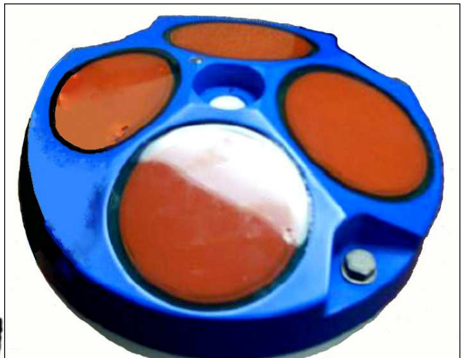
Le transducteur, placé sous le Cobra Tac, qui émet les faisceaux acoustiques et réceptionne leurs échos.
