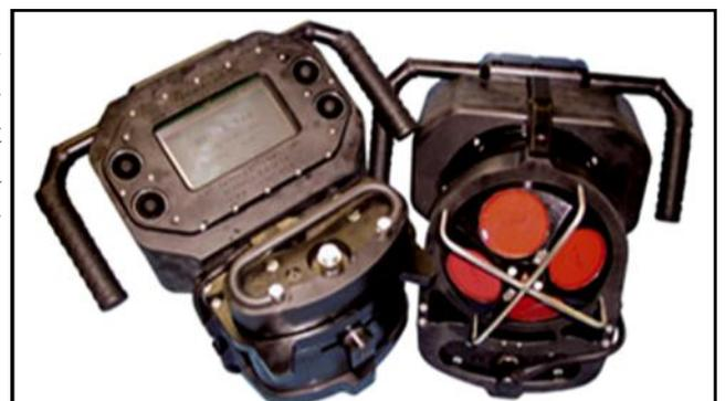
Le Cobra Tac vu du dessus et du dessous où apparaissent les émetteurs acoustiques dont la réflexion permettra d'enregistrer les mouvements.
