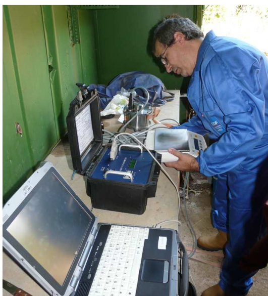
Photo 2- Étalonnage du fluorimètre GGUN d'EDF à Port Mioupar C. Perret (ph. BL)
